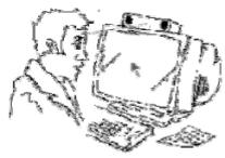
Un emettitore/ricevitore a raggi infrarossi viene sistemato sopra al monitor; da questa posizione esso capta il riflesso del raggio infrarosso emesso su una piccolissima targhetta metallica adesiva fissata sulla fronte o sugli occhiali dell'utente, ne rileva il movimento e lo trasforma nel movimento del puntatore del mouse sullo schermo.
