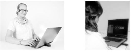
Un dispositivo con all'interno un giroscopio, posizionato sul capo dell'utilizzatore è in grado di rilevarne le variazioni di inclinazione; un software sul PC elabora questa informazione e trasforma i movimenti della testa nello spostamento del mouse sullo schermo.
